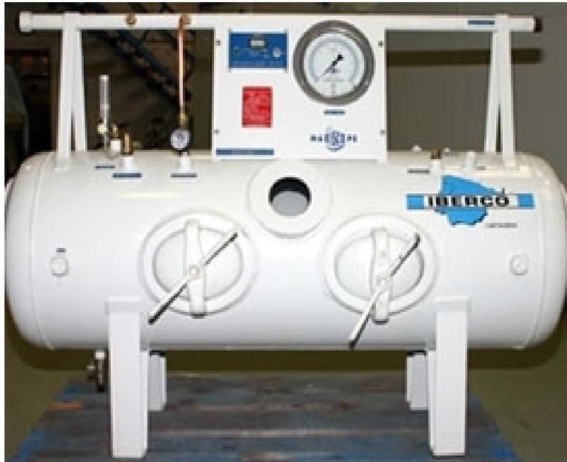
Figura 5.5. Esquema del simulador hiperbárico IBERCO – Modelo 50.
