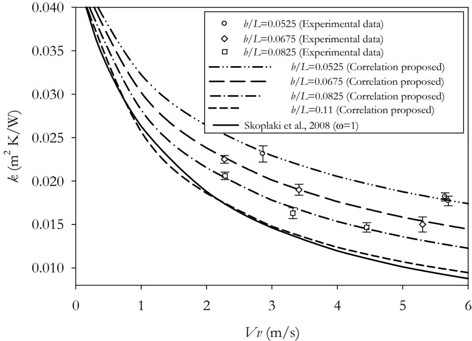
Figura 5.19 Resultados experimentales y correlaciones propuestas del coeficiente de Ross (k) medido para diferentes relaciones de aspecto y velocidades inducidas en el canal. Correlaciones experimentales propuestas por Skoplaki et al. [72] para sistemas PV no integrados en cubierta (w=1).
