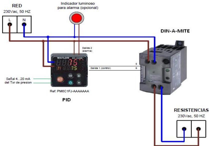
Figura 3.58 Diagrama de conexión entre DIN-A-MITE y PID.
