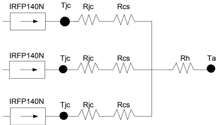
Figura C.10. Resistencia térmica
