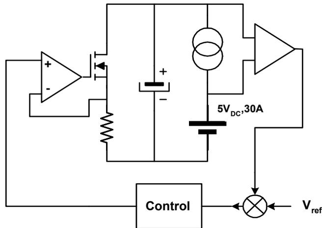
Figura C.13. Fuente de tensión para obtener tensiones negativas.
