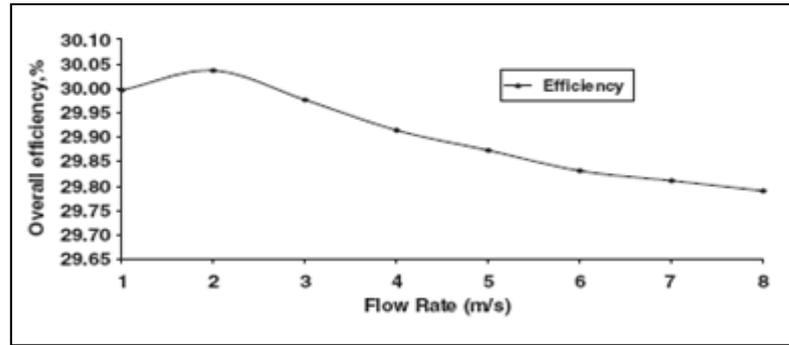
Figura 2.18 Efecto del caudal sobre la eficiencia global [19].
