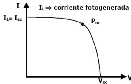
Figura 1.8 Curva característica de una célula fotovoltaica.
