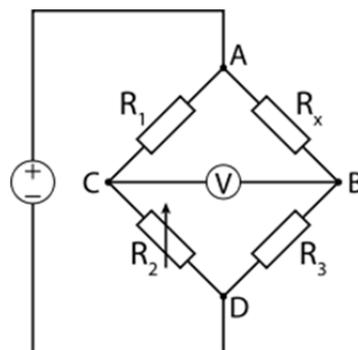
Figura 3.22 Esquema eléctrico del puente de Wheatstone.
