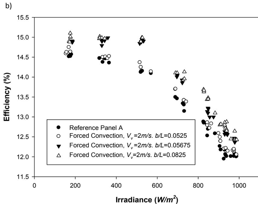
Figura 5.14 Influencia de la relación de aspecto en la temperatura y rendimiento del panel en función de la radiación solar para  $V_v=2$  m/s. a) Diferencia de temperatura del panel con el ambiente. b) Rendimiento del panel, para las diferentes relaciones de aspecto
