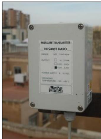
Figura 3.21 Transmisor de presión barométrica.
