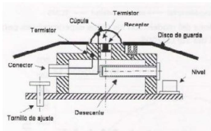
Figura 3.27 Esquema de la constitución interna del piranómetro.
