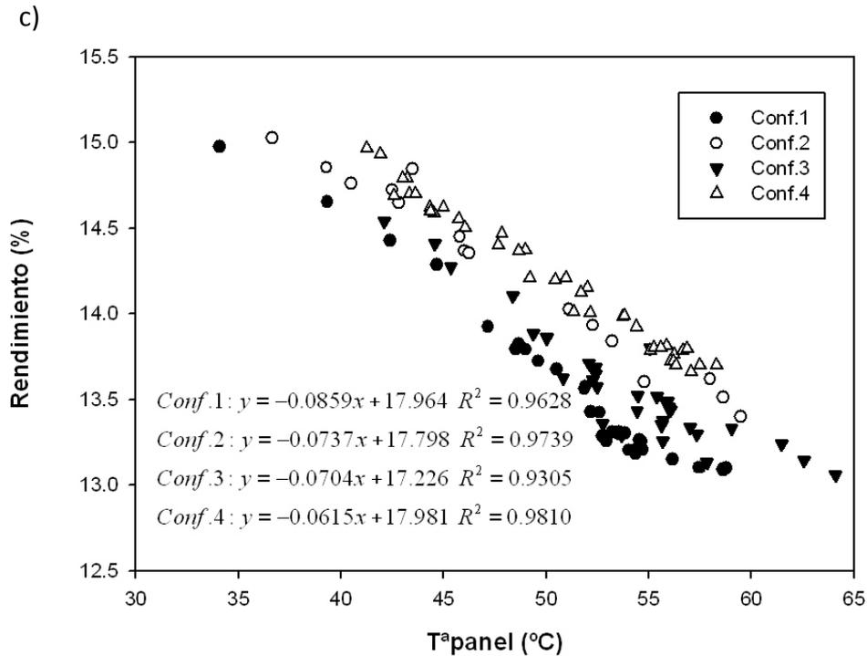
Figura 5.23 Dependencia con la temperatura de: a) la tensión de circuito abierto ( $V_{oc}$ ), b) la intensidad de cortocircuito ( $I_{sc}$ ) y c) el rendimiento.
