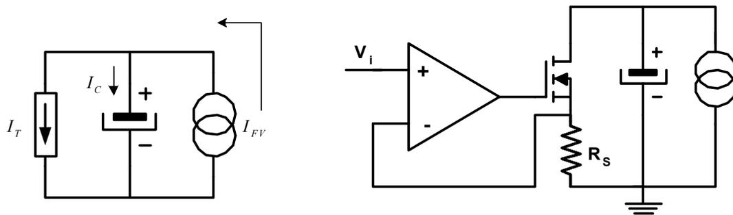
Figura C.4 Circuito simplificado. Fuente de corriente.
