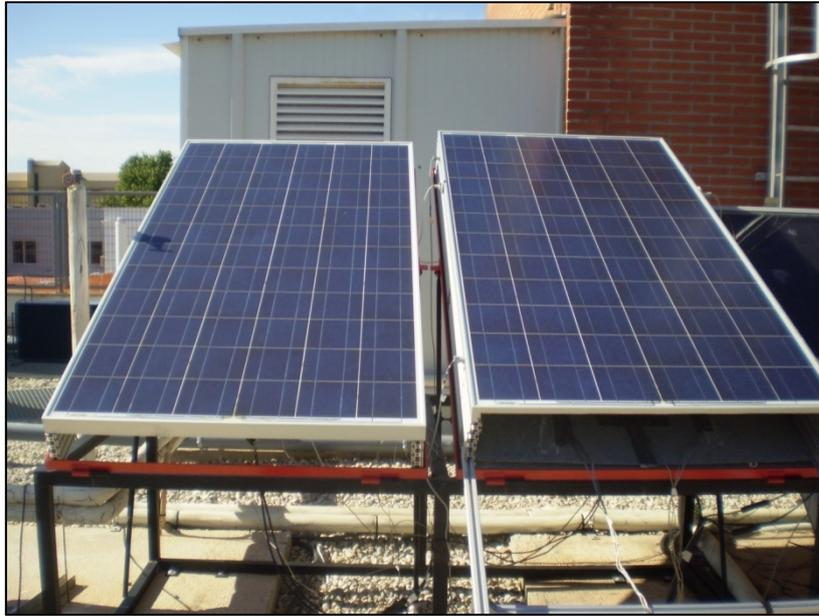
Figura 3.13 Instalación fotovoltaica experimental constituida por Panel A el izquierdo y Panel B el derecho en convección natural.
