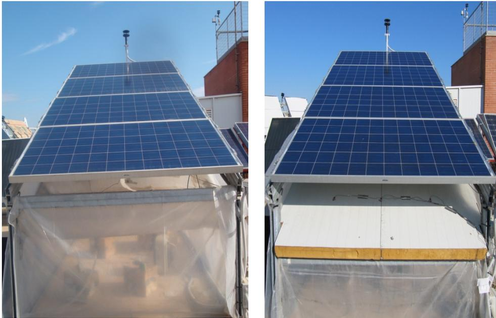
Figura 3.51 Fotografías de dos configuraciones estudiadas. Izquierda: Primera configuración con menor sección de aire de paso y con cubierta de plástico. Derecha: cuarta configuración con canal de aire de mayor sección y con aislante sobre la cubierta.
