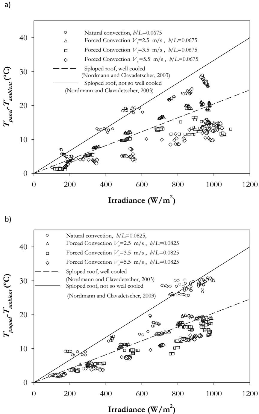
Figura 5.16. Diferencia entre temperatura de panel y ambiente en función de la radiación solar para diferentes niveles de velocidad inducida. a)  $b/L=0.0675$ . b)  $b/L=0.0825$
