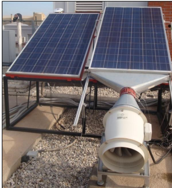
Figura 3.14 Instalación fotovoltaica experimental constituida por Panel A el izquierdo y Panel B el derecho en convección forzada.
