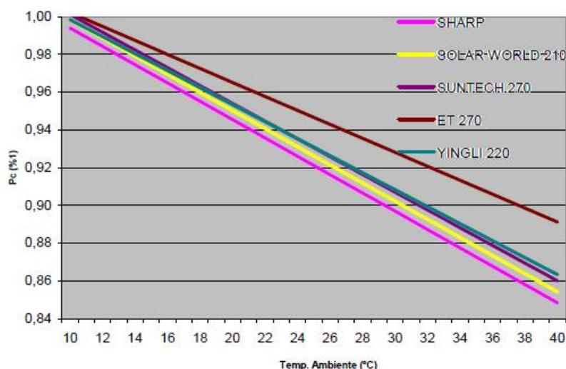
Figura 3.4 Variación del rendimiento teórico de de cada modelo de panel PV en función de la temperatura ambiente.
