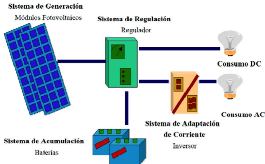
Figura A.27 Esquema de una instalación aislada de la red
