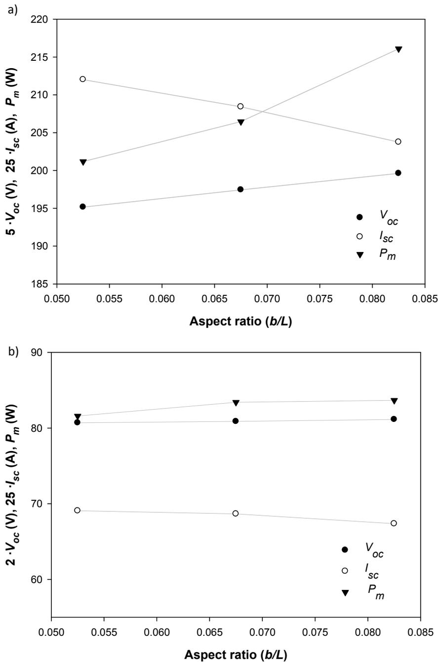
Figura 5.13 Influencia de la relación de aspecto sobre las variables eléctricas a diferentes condiciones ambientales. a) Alta radiación solar, con  $G_{\text{pira}}=970 \text{ W/m}^2$  y  $T^{\text{amb}}=29^\circ\text{C}$ . b) Media-baja radiación solar, con  $G_{\text{pira}}=225 \text{ W/m}^2$  y  $T^{\text{amb}}=23^\circ\text{C}$ .
