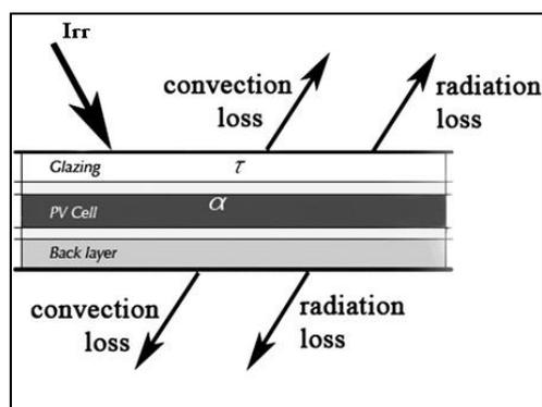
Figura 2.42 Esquema simple del proceso térmico de energía en un módulo fotovoltaico.
