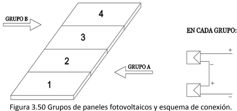
Figura 3.50 Grupos de paneles fotovoltaicos y esquema de conexión.
