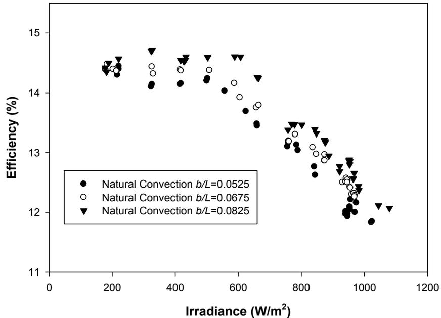
Figura 5.12 Influencia de la relación de aspecto en convección natural sobre el rendimiento eléctrico del panel.
