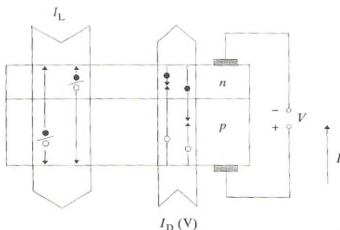
Figura 1.7 Componentes internas de la corriente en una célula fotovoltaica.
