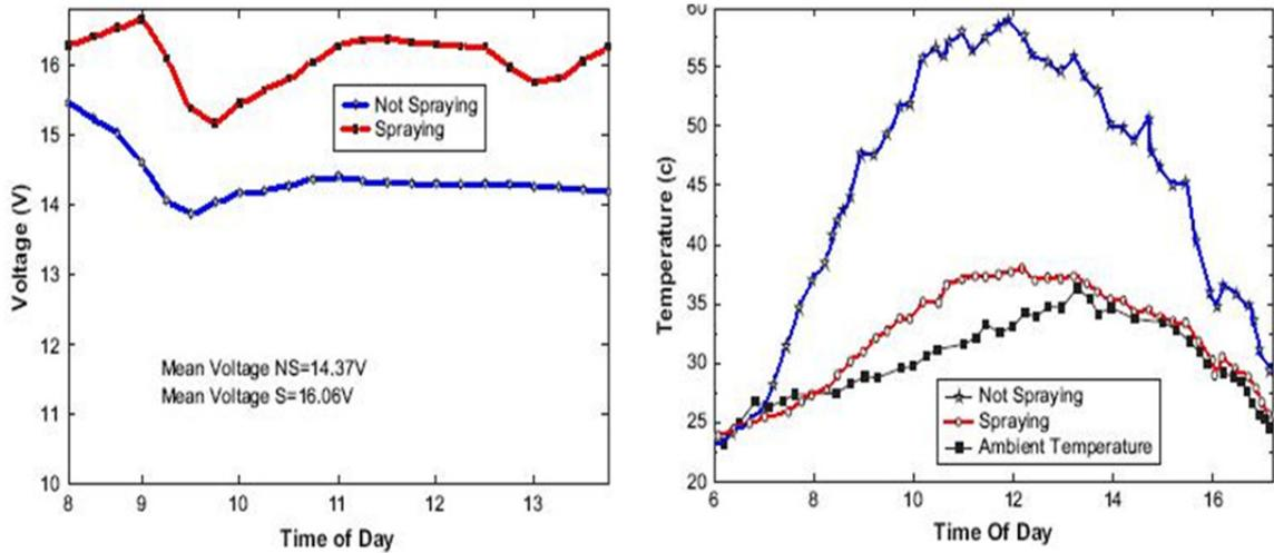
Figura 2.3 Comparación de los resultados medidos, con y sin pulverizar agua a lo largo del día de: a) La tensión del panel, b) temperatura de funcionamiento [3].
