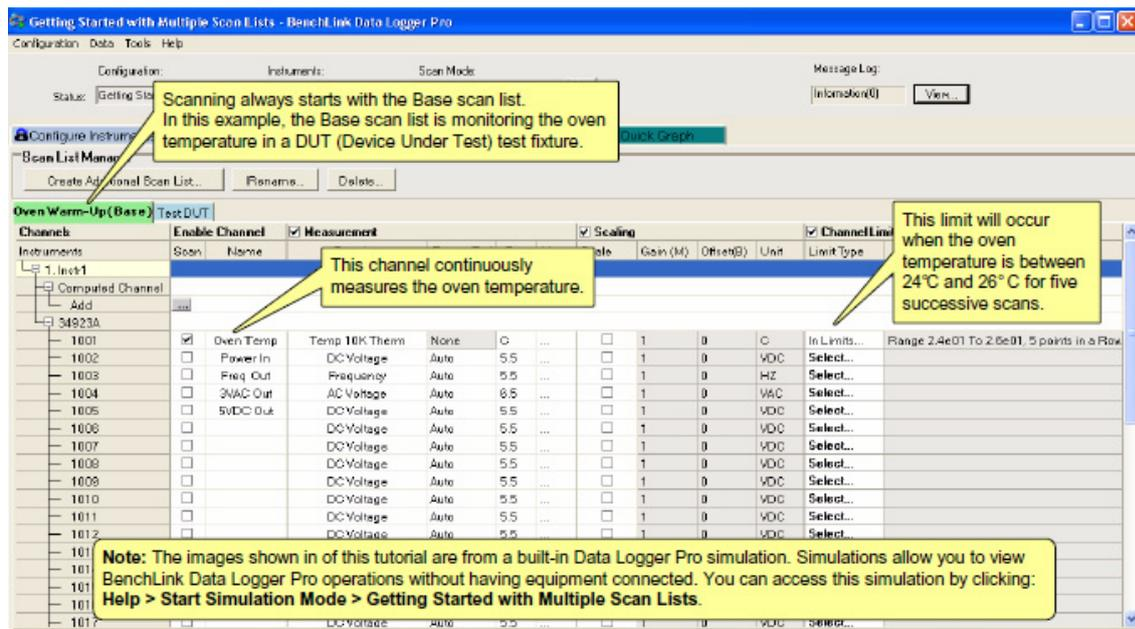
Figura 3.40 Ventana que muestra los canales conectados y permite su configuración.
