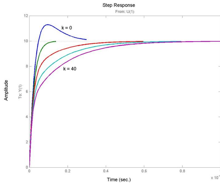
Figura C.6. Respuesta a escalón unitario con control PI
