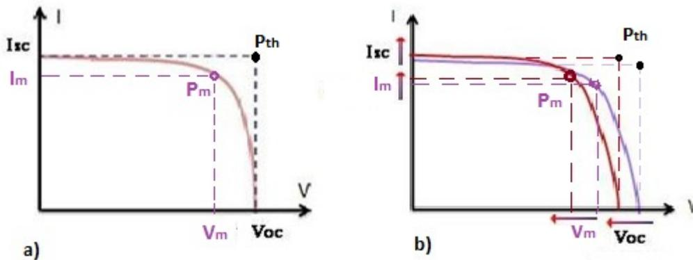
Figura 2.45 Influencia de un aumento de la temperatura en los parámetros que definen al Factor de Llenado. a) Representación del concepto del factor de llenado en la curva característica. b) Variación de los parámetros del factor de llenado con la temperatura.
