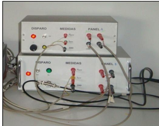
Figura 3.35 Carga electrónica para obtener la curva característica de los paneles fotovoltaicos.
