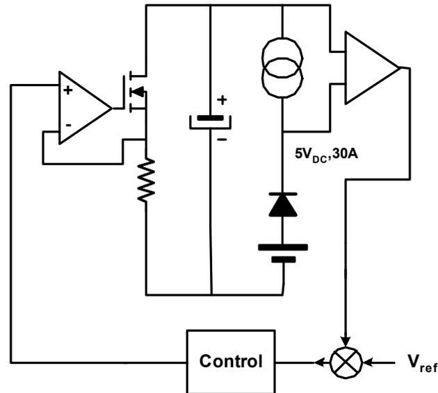
Figura C.14. Diodo de protección.
