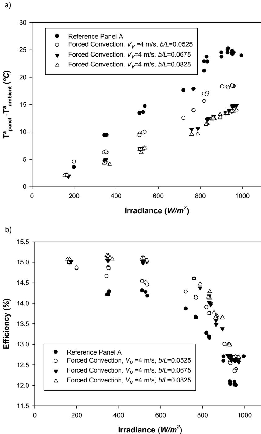
Figura 5.15 Influencia de la relación de aspecto en la temperatura y rendimiento del panel en función de la radiación solar para  $V_v=4$  m/s. a) Diferencia de temperatura del panel con el ambiente. b) Rendimiento del panel, para las diferentes relaciones de aspectos
