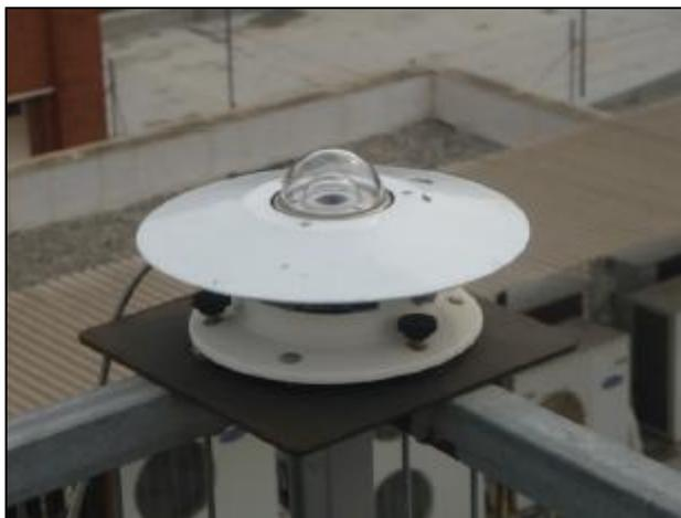
Figura 3.26 Piranómetro empleado para la medida de la radiación global.
