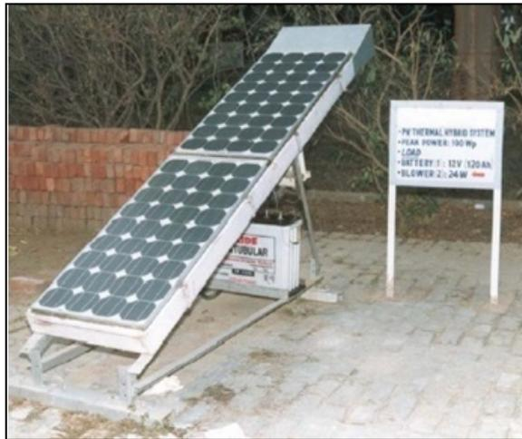
Figura 2.17 Módulos PV refrigerados por aire en su parte posterior [19].
