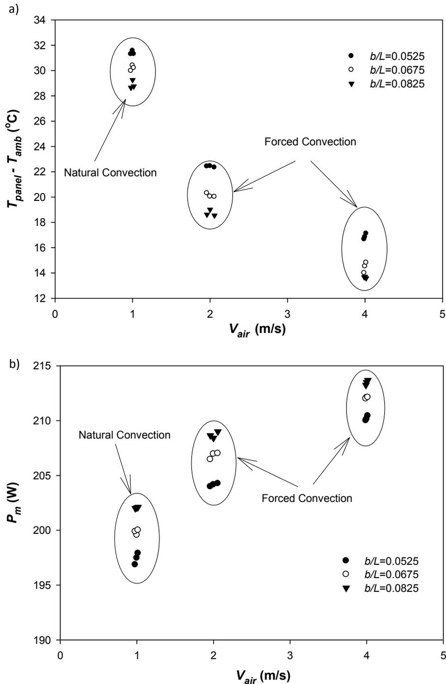
Figura 5.17 Comparación entre convección natural y forzada para las diferentes relaciones de aspecto, para una radiación de 950 W/m<sup>2</sup> y T<sup>a</sup>ambiente de 28°C. a) Potencia pico. b) Diferencia de temperatura del panel y ambiente.
