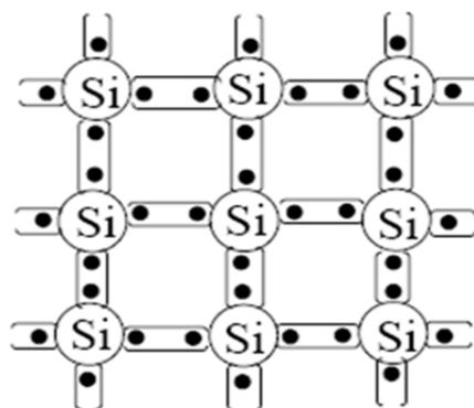
Figura A.4 Cristal de silicio intrínseco
