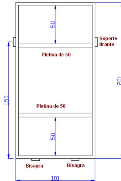
Figura 3.9 Estructura soporte del panel. Medidas en cm.
