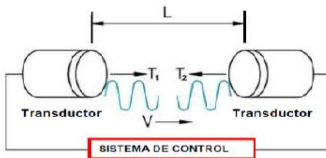
Figura 3.25 Esquema gráfico del funcionamiento del anemómetro ultrasónico.
