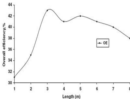
Figura 2.19 Efecto de la longitud del conducto eficiencia [19].
