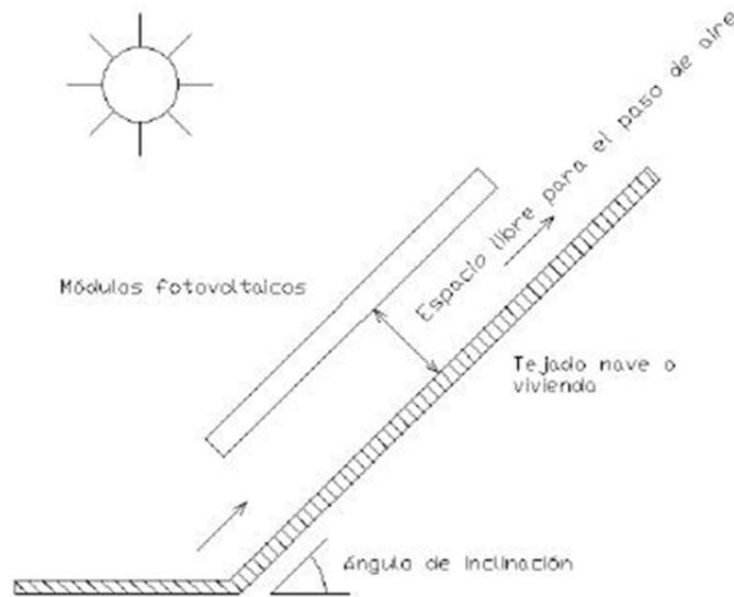
Figura 2.13 Convección natural en paneles fotovoltaicos [18].
