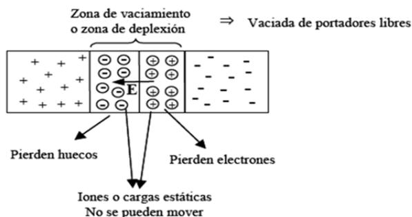
Figura A.7 Zona de deplexión en la unión p-n
