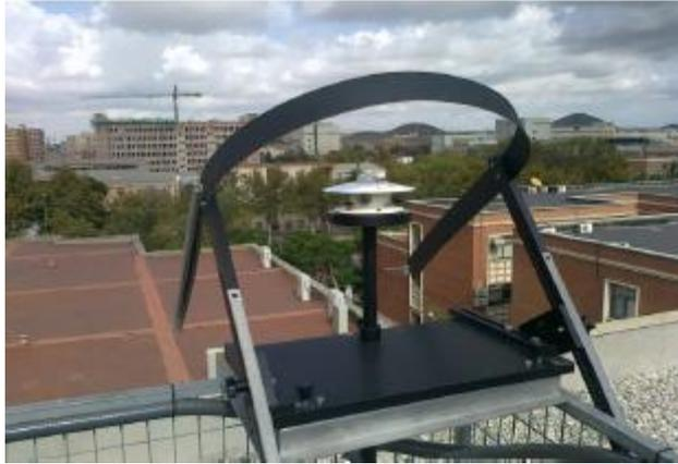
Figura 3.28 Banda de sombra del piranómetro que registra la radiación difusa.
