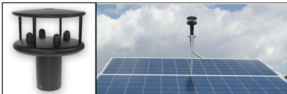
Figura 3.54 Anemómetro Windsonic y su ubicación en la instalación experimental.
