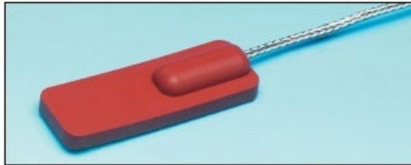
Figura 3.31 Sonda flexible Pt100 utilizada para medir la temperatura de la cara posterior de los módulos fotovoltaicos
