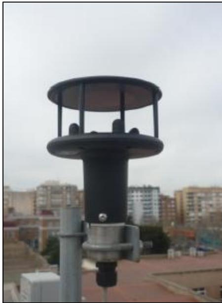
Figura 3.24 Anemómetro ultrasónico.
