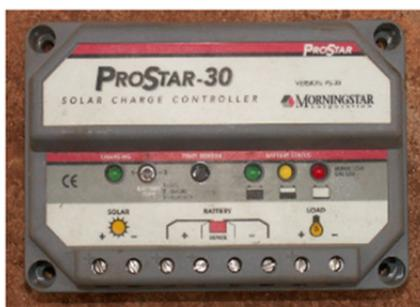
Figura A.24 Controlador de carga solar de 30A para un campo de paneles de corriente máxima 25A.
