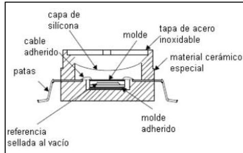
Figura 3.23 Esquema de un sensor piezoresistivo.
