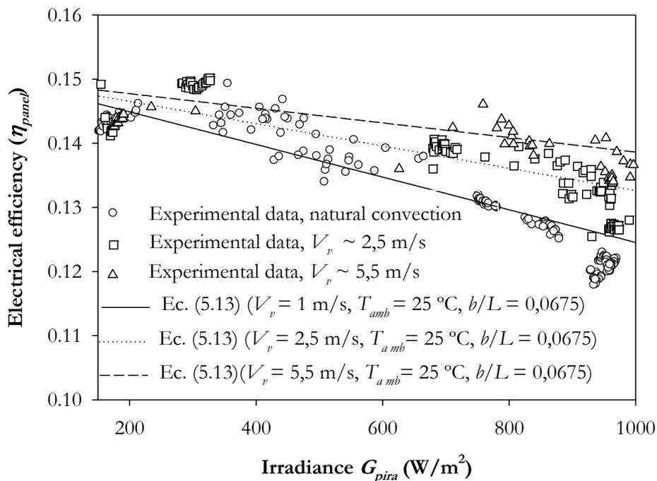
Figura 5.21 Comparación entre los datos experimentales de la eficiencia eléctrica con la correlación propuesta para diferentes valores de velocidad inducida,  $b/L=0.0675$  y  $T_{amb}=25^\circ\text{C}$  [77].
