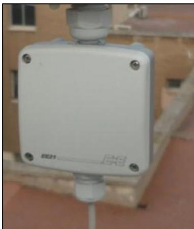
Figura 3.16 Fotografía del transmisor de humedad relativa y temperatura ambiente.
