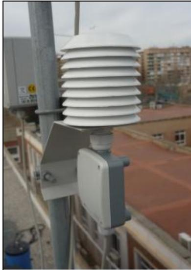
Figura 3.20 Dispositivo de protección a la radiación solar.
