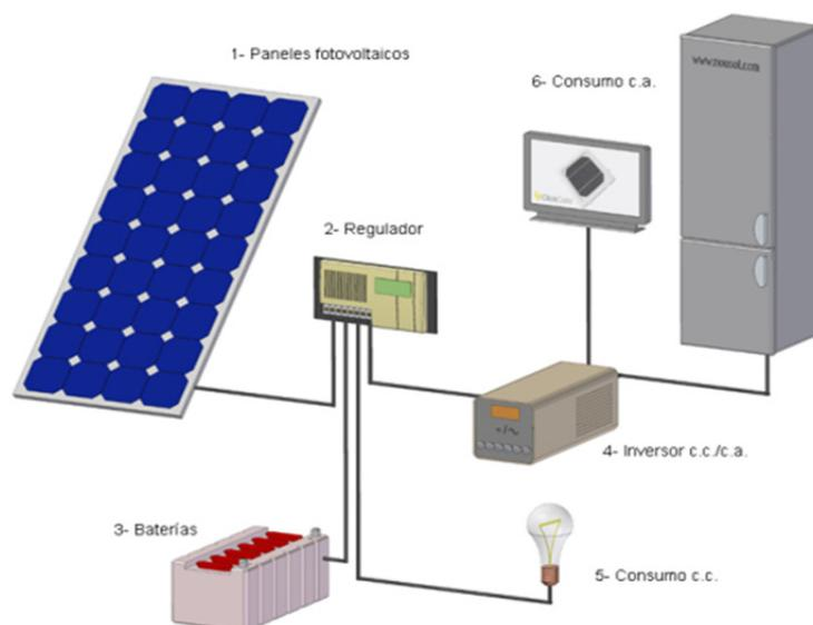
Figura A.21 Elementos del sistema fotovoltaico
