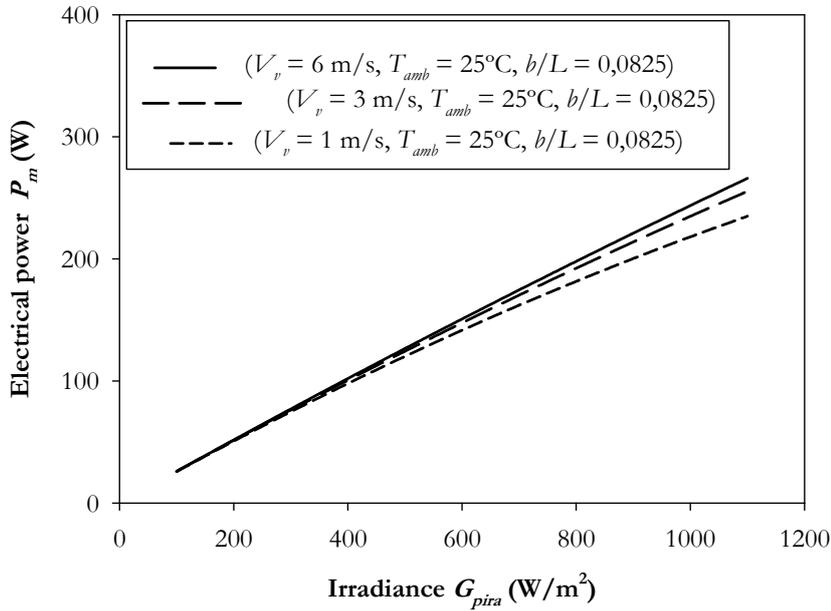
Figura 5.22 Influencia de la velocidad inducida del aire en el canal sobre la potencia pico del panel fotovoltaico en función de la radiación solar, a partir de la correlación propuesta para  $b/L=0.0825$  y  $T_{amb}=25^{\circ}\text{C}$ .
