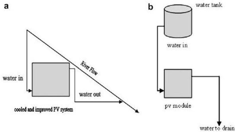
Figura 2.9 Diagrama del sistema de refrigeración [12].
