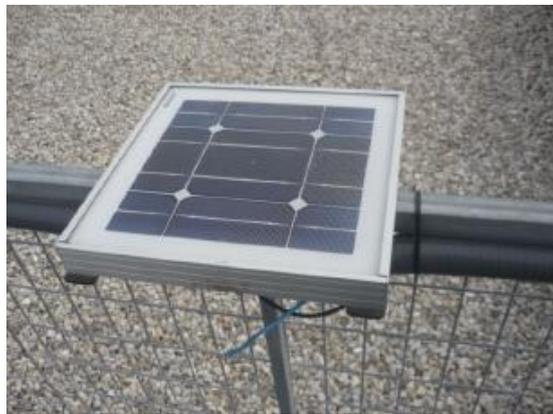
Figura 3.29 Célula fotovoltaica calibrada.
