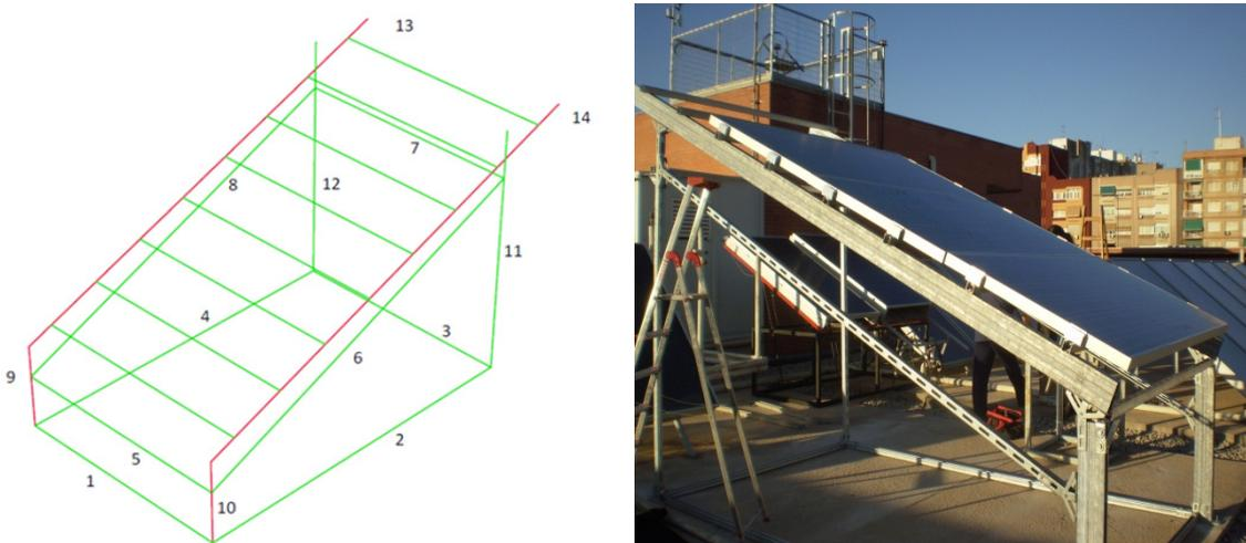
Figura 3.47 Esquema de la estructura con identificación de los perfiles (izquierda) y fotografía de la estructura construida (derecha).
