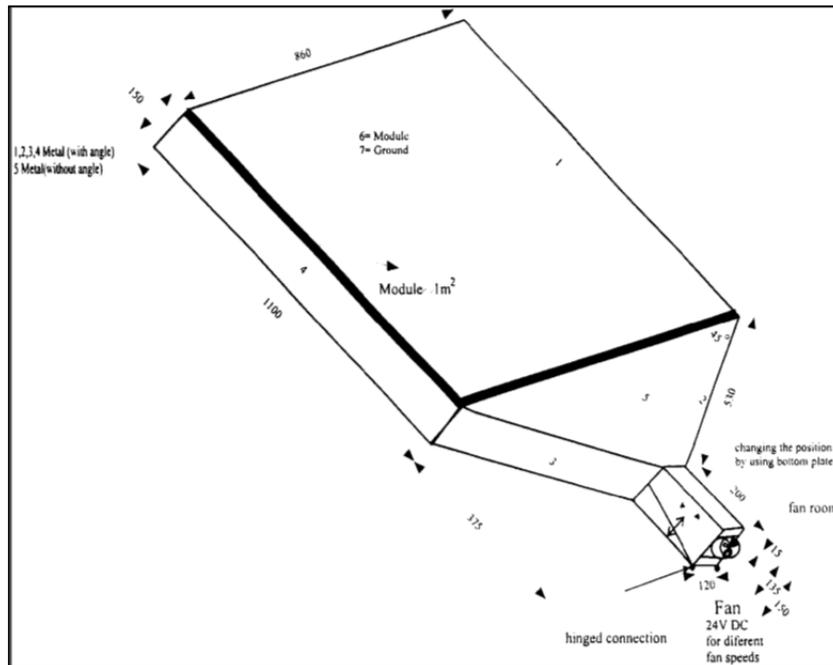
Figura 2.27 Modelo del conducto de aire para refrigerar el módulo PV [22].
