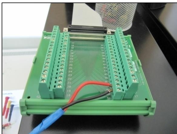
Figura 4.1 Fotografía de la tarjeta utilizada para el disparo de la carga electrónica.
