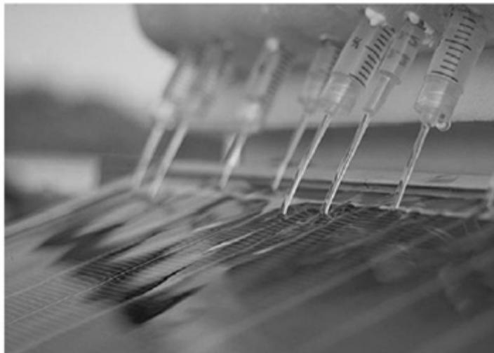
Figura 2.6 Creación de la capa de agua sobre el módulo PV a través de las boquillas [2].
