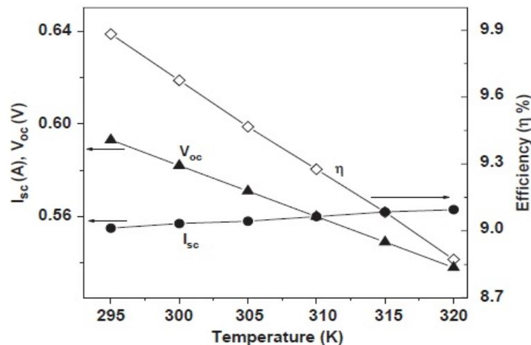
Figura 2.49 Variación de la tensión de circuito abierto, intensidad de cortocircuito y eficiencia con la temperatura para una célula de silicio en el rango de temperatura de 295 – 320K [51].
