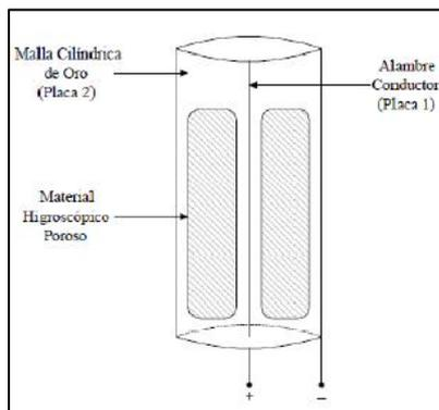
Figura 3.18 Esquema de construcción del dieléctrico
