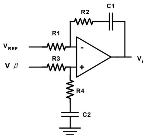
Figura C.5. Control Proporcional-Integral.
