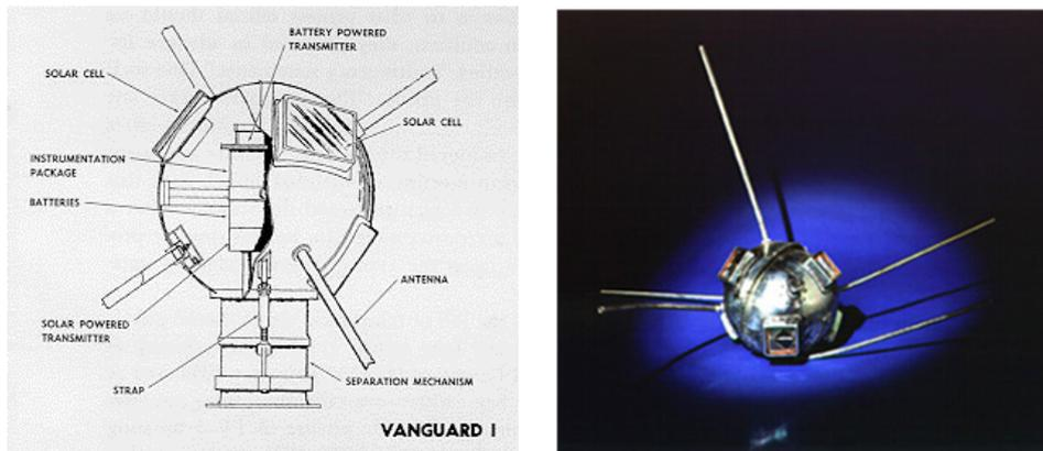
Figura 1.4 Primer satélite con placas solares, Vanguard I.
