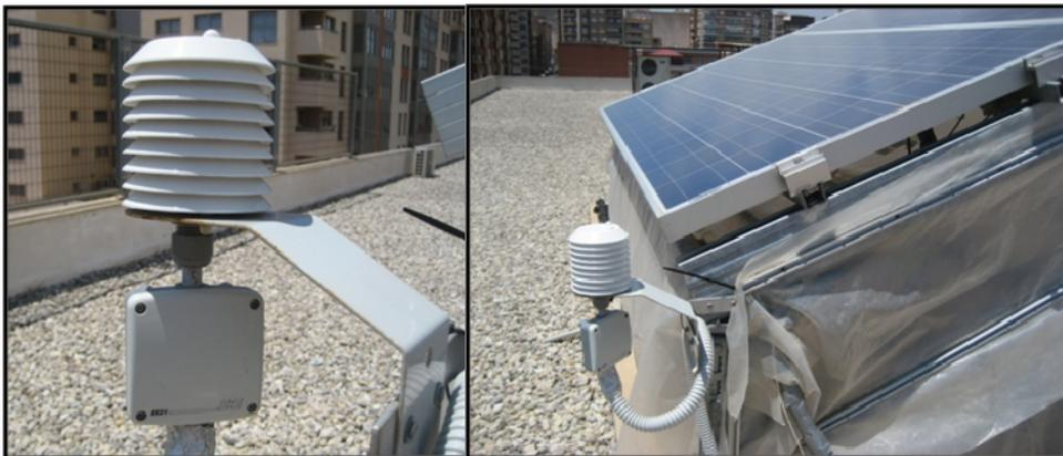
Figura 3.53 Transmisor de la temperatura ambiente y su ubicación en la instalación experimental.
