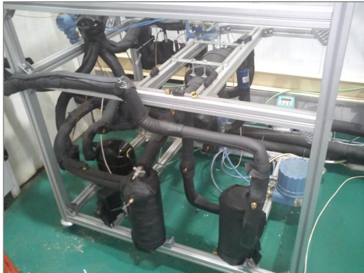
Figura II.6: Fotografía del circuito de refrigerante.
