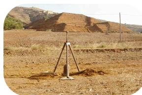
te el proceso de extracción y transporte de la muestra. El equipo patentado está compuesto por una carcasa, una cabeza que imprime la fuerza para penetrar en el suelo, una base cortante y un tubo interior que aloja la muestra inalterada. Además, dispone de accesorios para el transporte y análisis y en el laboratorio. La muestra extraída tiene un diámetro de 15 centímetros y puede llegar hasta los sesenta centímetros de profundidad.
