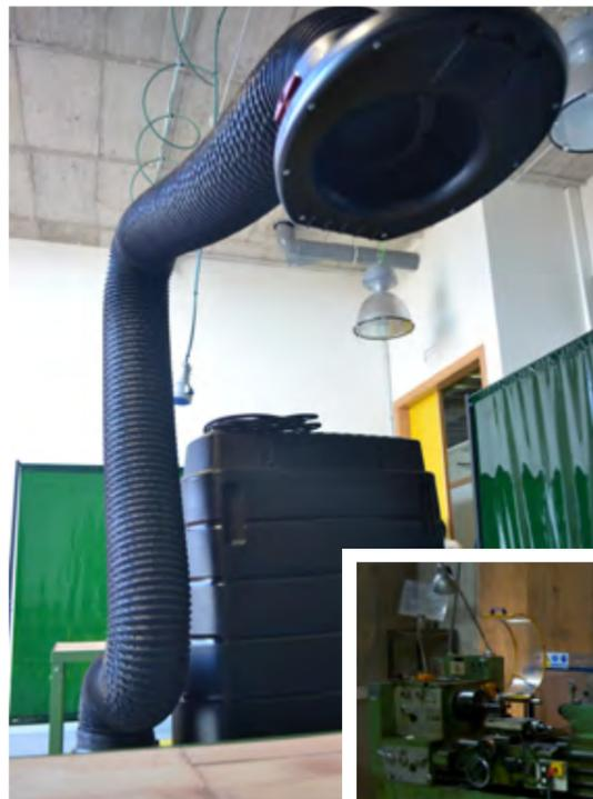
Se ha dotado al departamento de Ingeniería de Materiales y Fabricación de cabinas de soldado y equipos de extracción de gases de soldadura portátiles
