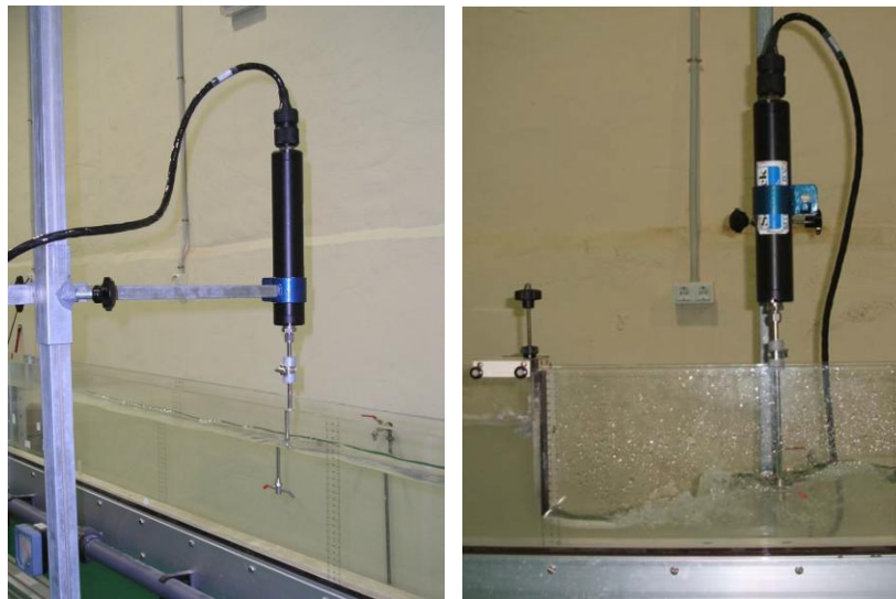
Figura 7. Medición de velocidades en resaltos con equipos Doppler
