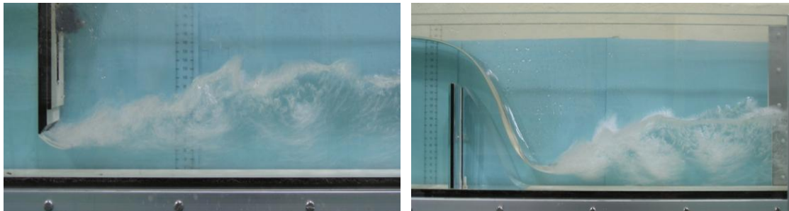
Figura 4. Resalto hidráulico obtenido en laboratorio aguas abajo de una compuerta plana y de un vertedero hidrodinámico
