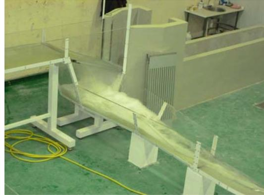
Fig.3 Detalle del paso del agua a través de la reja.
