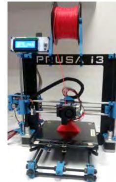
Fig. 2. Impresión de un bloque de impacto
