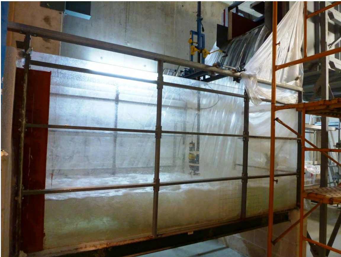
Figura 2 | Infraestructura de vertido libre en laboratorio. ( q=0.082 \text{ m}^2/\text{s} , H=2.19 \text{ m} , Y=0.32 \text{ m} ).
