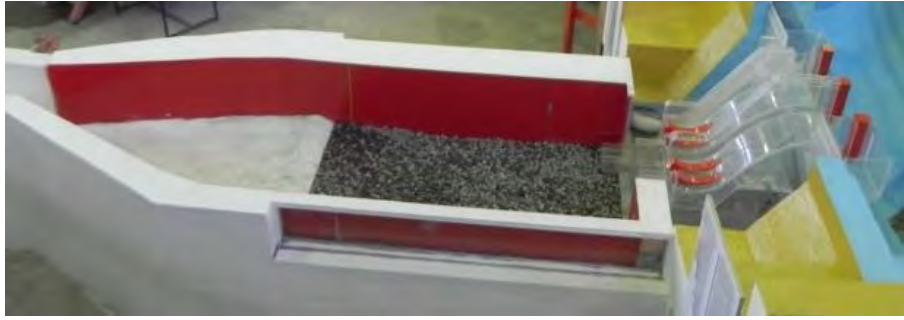
Figura 2.- Modelo físico del trampolín de lanzamiento de la presa Toachi.
