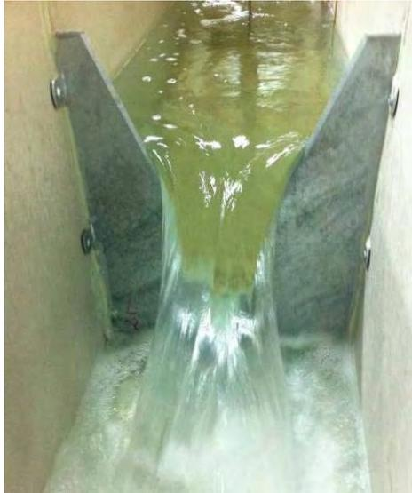
**Figura 2.14.** Vista del vertedero V-notch 45° instalado.
