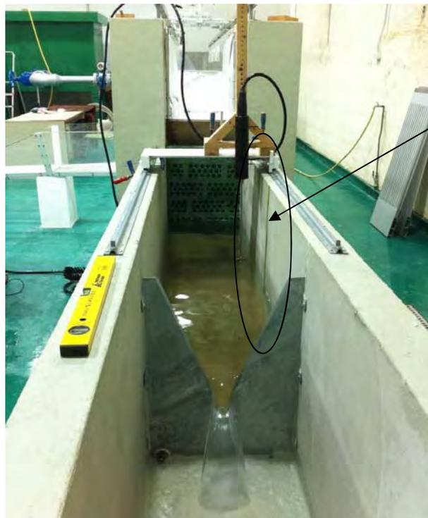
Regla graduada para medir la lámina de agua sobre el vertedero.
