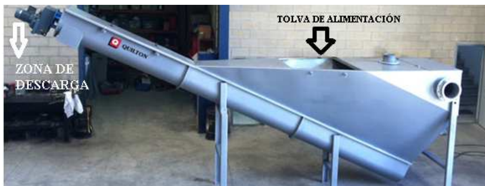
Figura 27: Clasificador lavador de tornillo sin fin de la marca Quilton. Fuente: Internet.
