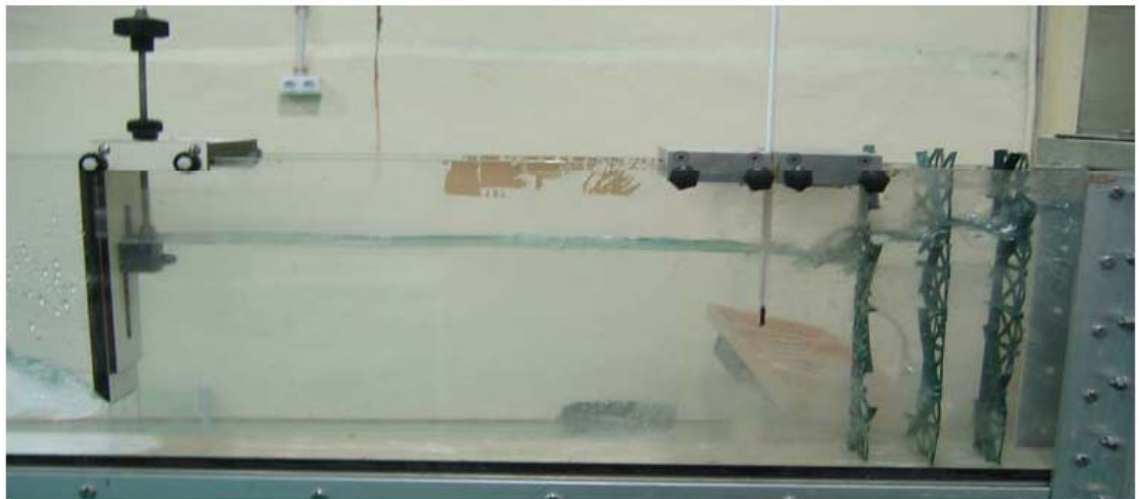
Figura 3.14. Tranquilizadores de flujo aguas arriba de la compuerta, Márquez (2006)
