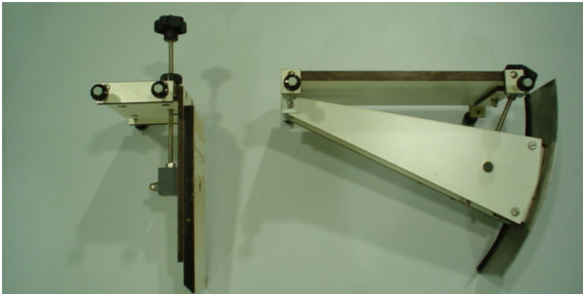
Foto 2. De izquierda a derecha, vertedero de pared delgada, de pared gruesa y perfil hidrodinámico (aliviadero).
