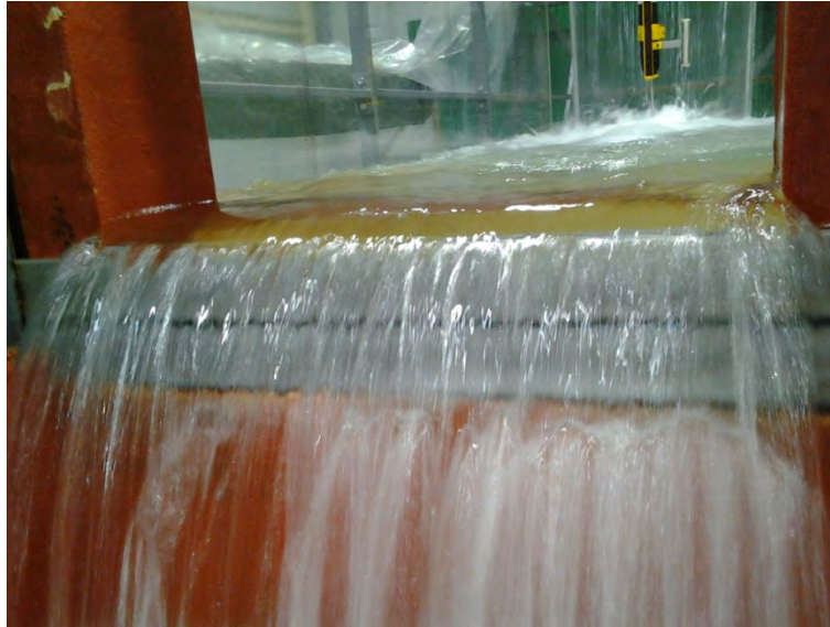
Figura 32: Barreras de acero situadas aguas abajo del cuenco de amortiguación.
