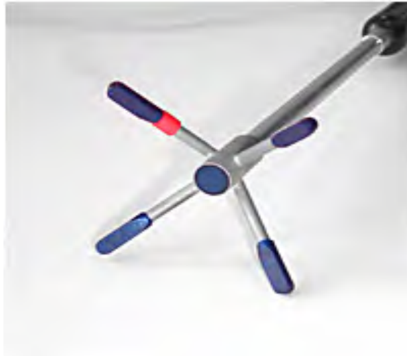
Figura 43: Configuración de los cuatro receptores de la sonda Vectrino ( http://www.nortek-as.com , 2012).
