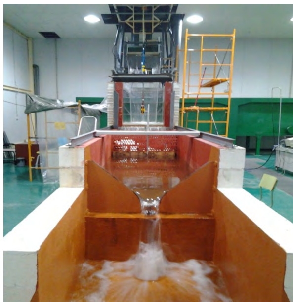
Figura 27: Infraestructura de vertedero de caída libre.
