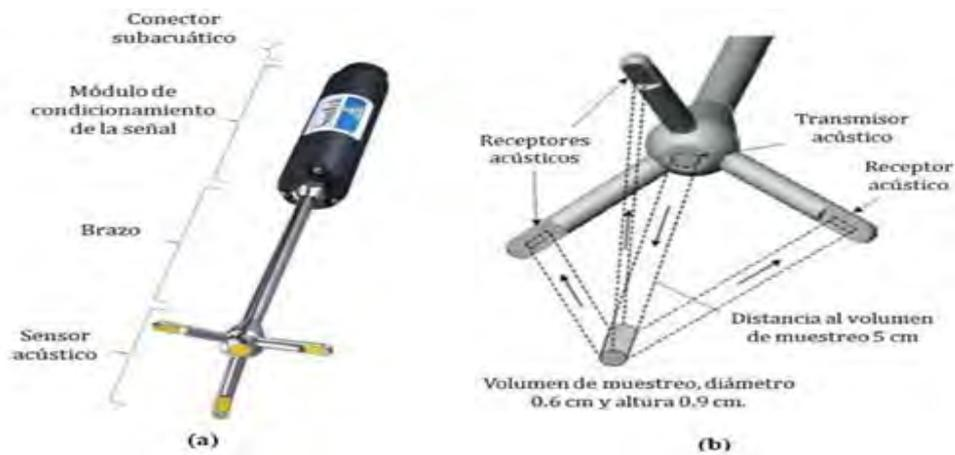
**Figura III.9: (a) Partes de la sonda ADV. (b) Detalle del sensor acústico (Molina Miñano, 2010).**
