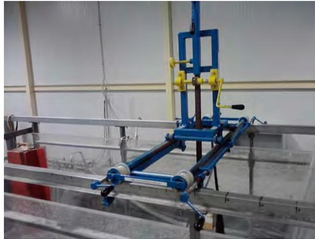
**Figura III.6: Mecanismo de sujeción de la Sonda Doppler.**
