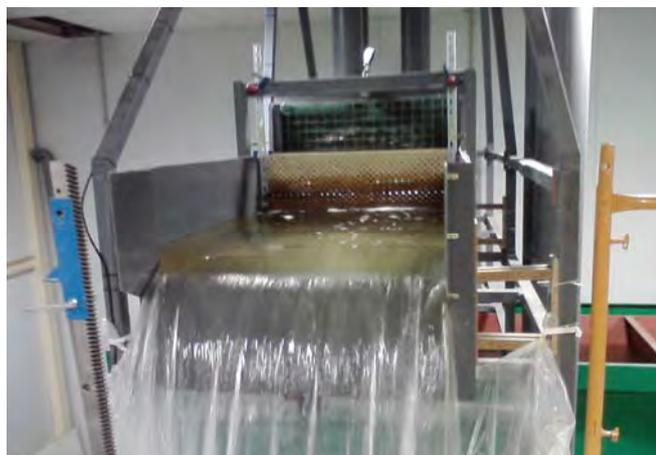
**Figura III.3: Detalle del cajón superior que constituye el vertedero de labio fijo.**
