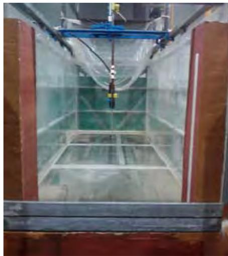
**Figura III.5: Detalle de barreras que conforman la contrapresa.**
