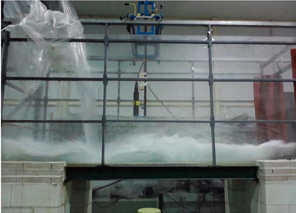
**Figura 6: Recolección de datos para un colchón de 12.5 cm, generado por una barrera.**
