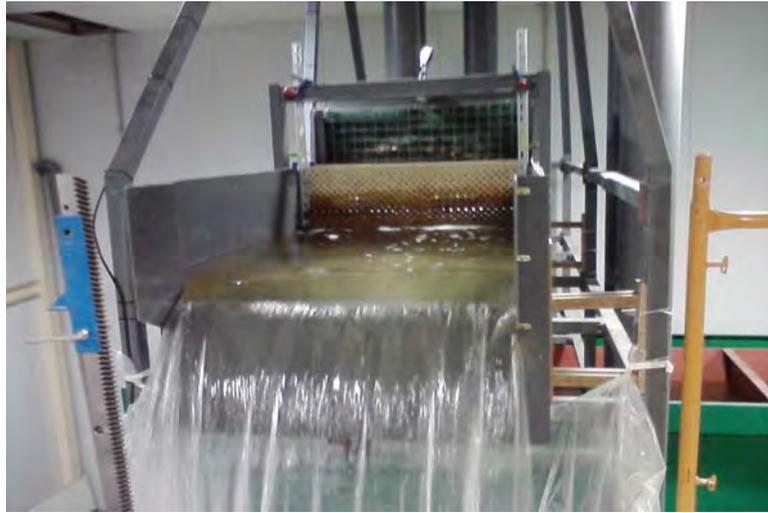
**Figura 3: Detalle aguas arriba del aliviadero provisto de un tranquilizador de fluido.**
