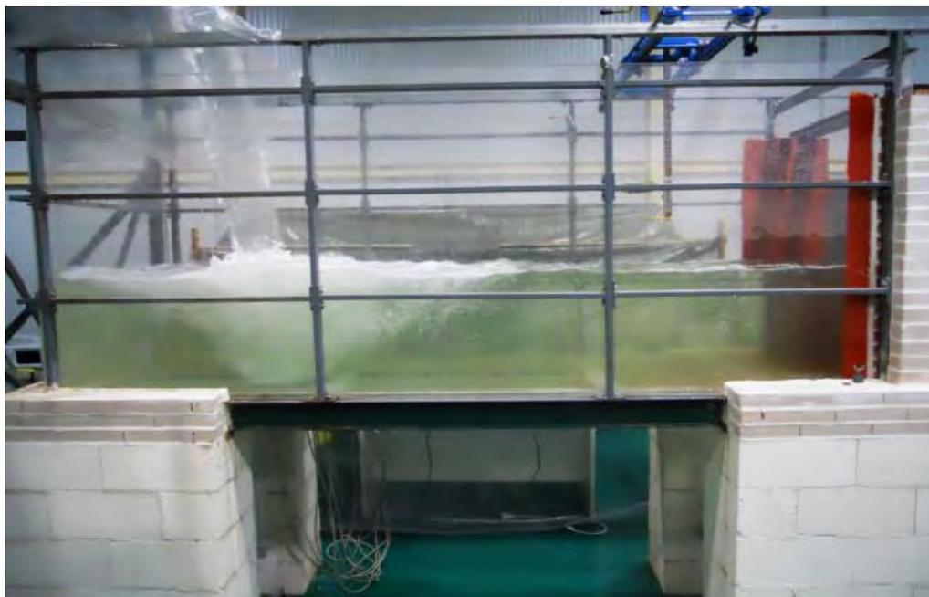
**Figura 7: Evolución del resalto hidráulico para un caudal de 30.67l/s.**
