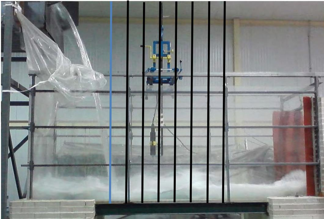
**Figura VI.2: Distribución de secciones de estudio en el cuenco de amortiguación.**
