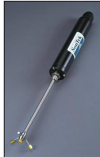
velocidad más baja que cubra la velocidad máxima esperada en un ensayo dado. El ruido generado por el instrumento en los datos de velocidad es proporcional a la configuración de rango de velocidad; altos rangos de velocidad tienen niveles de ruido más altos.
