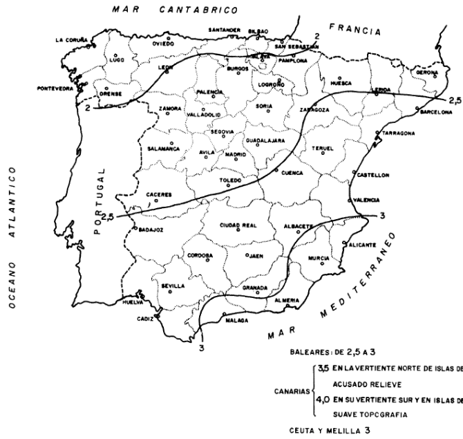
Figura 1-11. Mapa del coeficiente corrector del umbral de escorrentía
