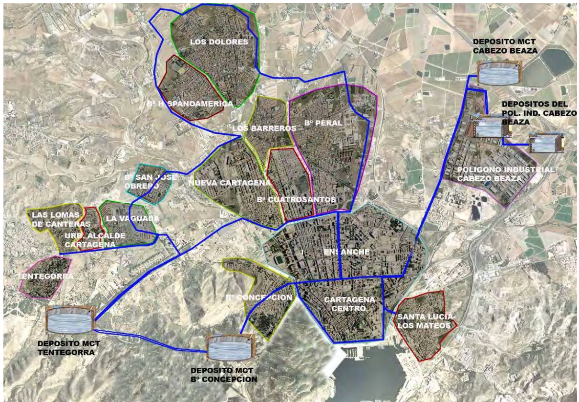
Figura 3.3. Esquema de la distribución de agua de la ciudad de Cartagena
