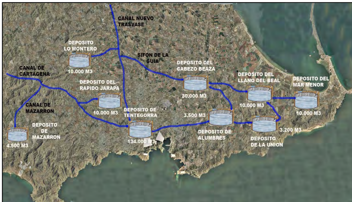
Figura 3.1. Esquema de procedencia del agua suministrada
