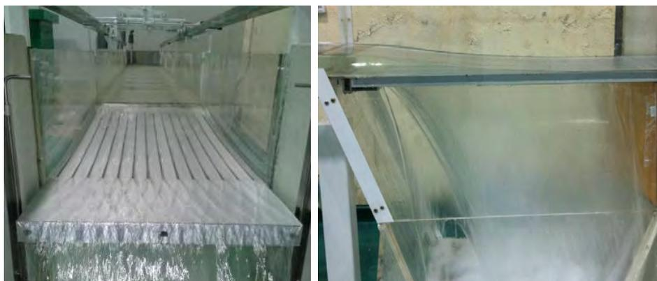
*Fig.2 Detalle del flujo a su paso por la reja.*
