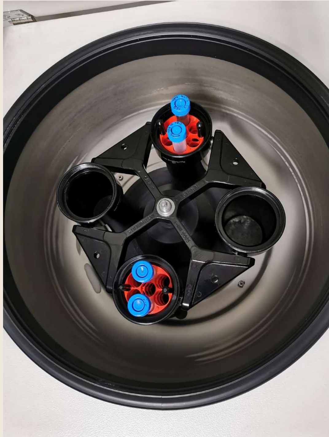
Disposición de los tubos de ensayo en el rotor orbital de la centrífuga
