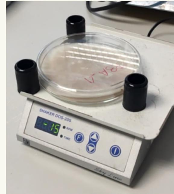
6. Se pone en el agitador orbital durante 15 minutos a 150 rpm.
