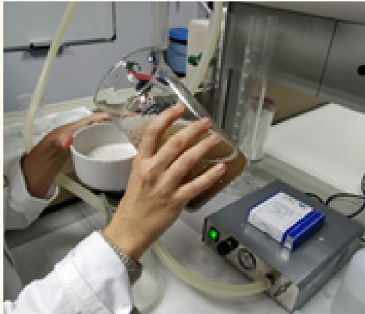
4. Después se filtra en una bomba de vacío usando un filtro de papel.
