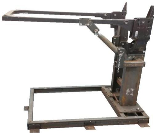
Para la construcción del banco de ensayo se ha puesto la condición de que el sistema sea capaz de suministrar suficiente potencia en las condiciones de ensayo más desfavorables que permitan que el arco se encuentre en posición vertical arrancando desde la horizontal en menos de 400 ms.
