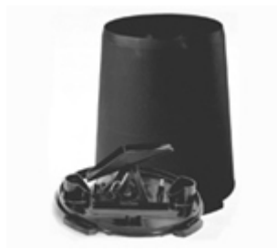
Figura 10. Pluviómetro electrónico de cazoleta
