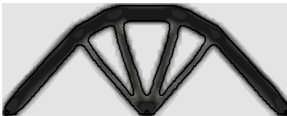
(a) Aptitud = 56,20 \cdot 10^{-6} \text{ N}^{-1} \text{ mm}^4 ; Compliance = 54,50 Nmm Malla de 104 \times 44 elementos (4 nodos, 1 \times 1 Gauss)
