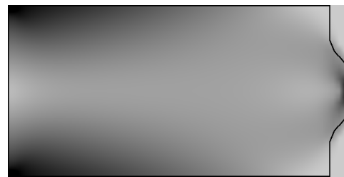
(b) Generación 37 Aptitud = 2,461 \cdot 10^{-7} \text{ N}^{-1} \text{ mm}^{-4} ; V/V_0 = 0,963
