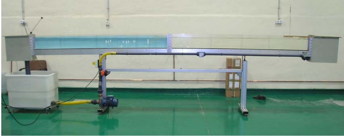
Fotografía I-1. Canal de estudio en el que se aprecian las deflexiones existentes en los extremos.
