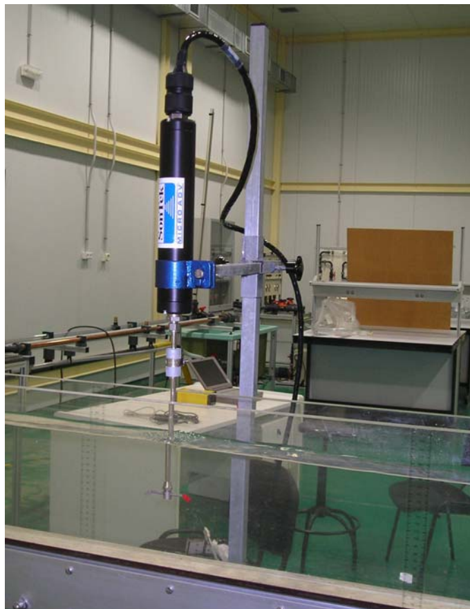
Soporte para la sonda ADV.
