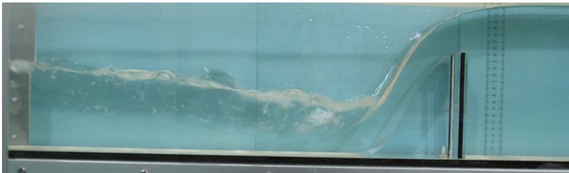
Fotografía I-6. Resalto sumergido tras aliviadero WES.
