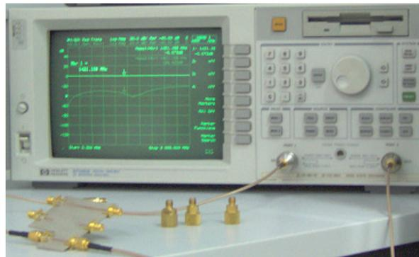
*Figura A-17 Medida de los parámetros S de la línea THRU*
