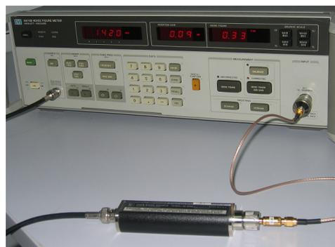
**Figura 3.1-44 Fotografía del proceso de calibración del equipo de Medidor de la Figura de Ruido**
