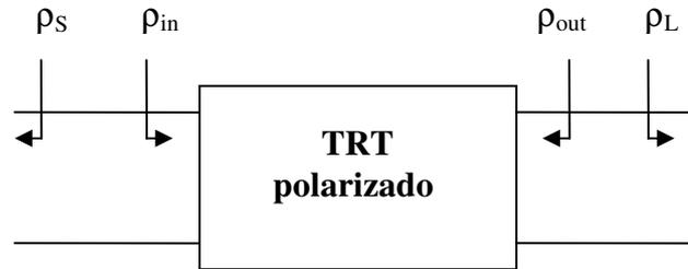
*Figura 3.2-8 Esquema simplificado de los coeficientes de reflexión del subcircuito*
